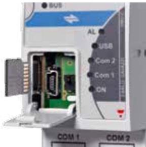
Das VMU-C EM verfügt über einen internen Speicherplatz von 4 GB. Dies ermöglicht die Speicherung der Daten von 32 3-Phasen-Zählern über einen Zeitraum von bis zu 30 Jahren. Zur externen Datensicherung bietet das VMU-C EM zusätzlich an der Gerätefront einen Micro-SD-Slot. Eine Hot-Swap-USB-Schnittstelle auf der Oberseite dient dem direkten Anschluss eines Speichersticks, um im Fehlerfall ein „Disaster Recovery“ durchzuführen.
