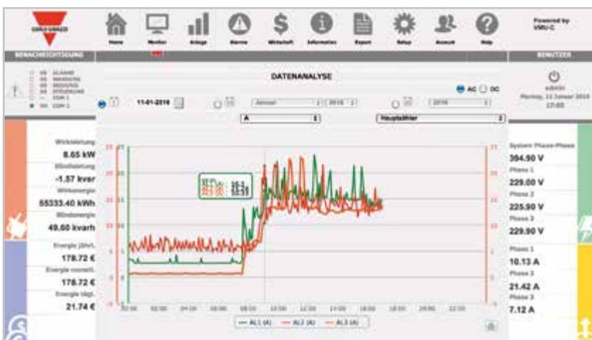
Die aufgezeichneten Momentanmesswerte des Hauptzählers – und somit die Werte der gesamten Elektroinstallation – können mittels Tages-, Monats- oder Jahresdiagramm analysiert werden.
