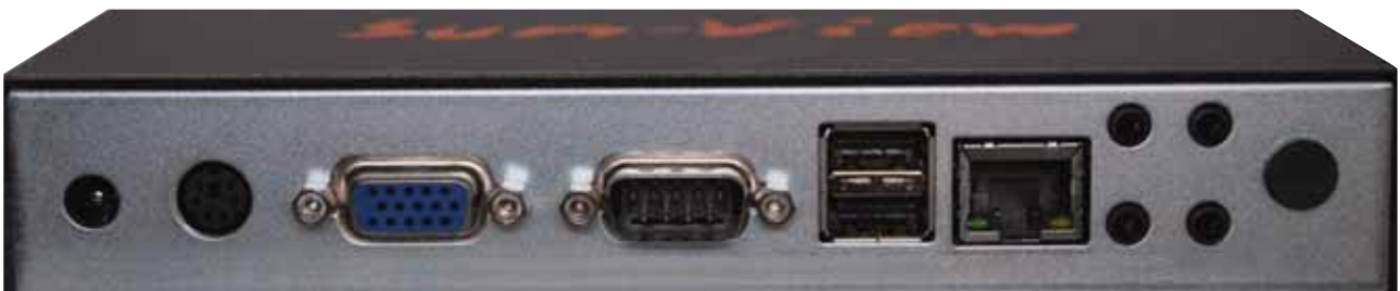
Anschlüsse des Datenloggers
